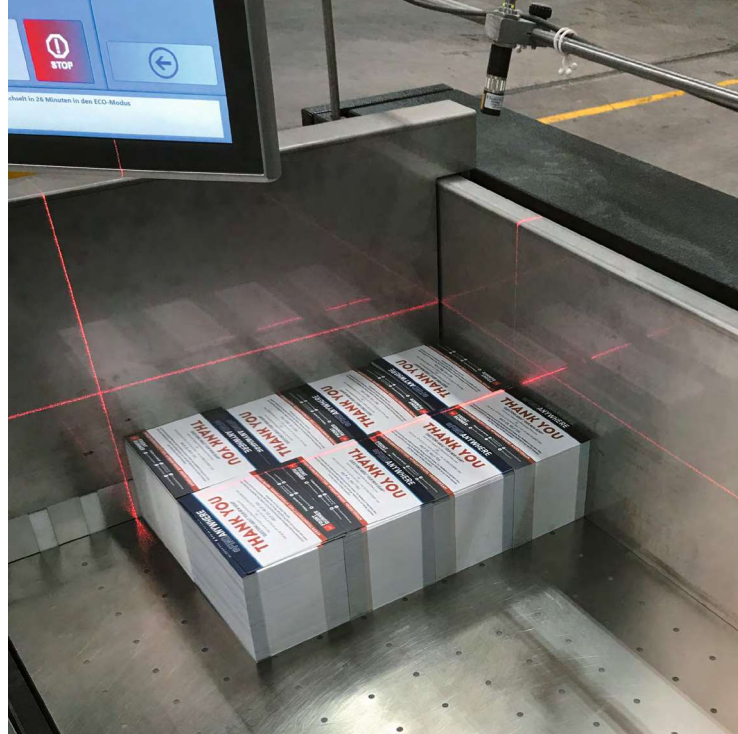
Dank der automatischen dreidimensionalen Vermessung der zu verpackenden Produkte sind die Schachteln nicht viel größer als die Produkte.
