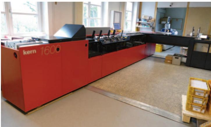
*Mit einer Geschwindigkeit von bis zu 12.000 Takten/Std. ist das Kompakt-Multiformat-System Kern 1600 die Kuvertier-Lösung für Lettershop Wiest.*
